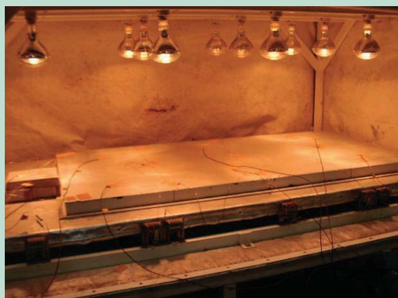
ゴーレックスボード 赤外線照射寸法安定性試験
